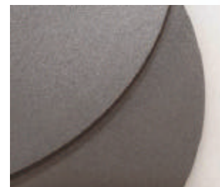
Grafito de granulado fino resistente a las altas temperaturas, para ser utilizado por ej. en la Industria de los Semiconductores.
