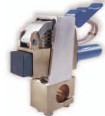
*Portaescobillas especiales para turbogeneradores, que facilita cambiar los portas con la máquina en marcha sin peligro alguno. Sencillo control de desgaste de la escobilla, elementos con pinzas enchufables para máquinas excitatrices, diseños sencillos y múltiples.*
